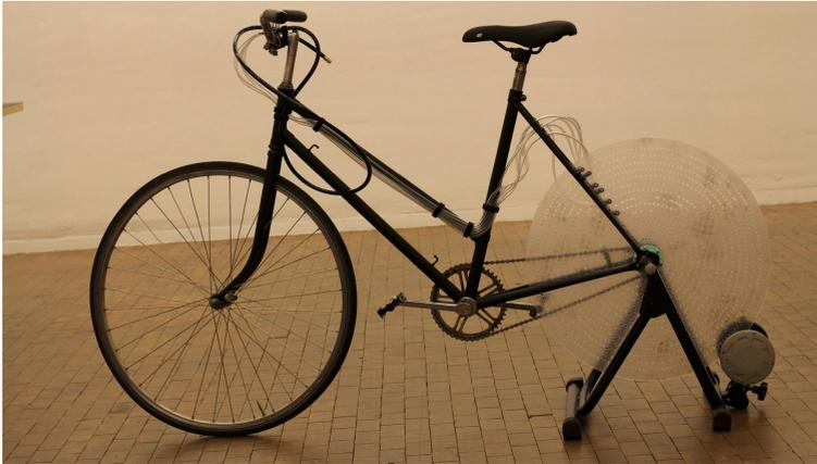
Abbildung 2: Das Sirenenfahrrad nach Helmholtz. Bei diesem modifizierten Fahrrad ist das Hinterrad durch eine Lochscheibe ersetzt. Die Luftzufuhr erfolgt über einen Kompressor (nicht im Bild). Über Ventile am Lenker können bis zu sechs Lochreihen angesteuert werden. Die Drehgeschwindigkeit der Lochscheibe und damit die Tonhöhe wird durch das Treten der Pedale gesteuert.
